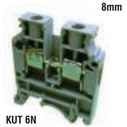
KUT 6N 800V/41A/6sq mm/0.8Nm
